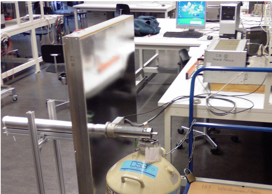
Abbildung 4.4.: Foto des Versuchsaufbaus mit (von links) Stativ mit Quelle, TRD-Radiator, Halbleiterdetektor mit Stickstofftank, Auslese-Elektronik.
