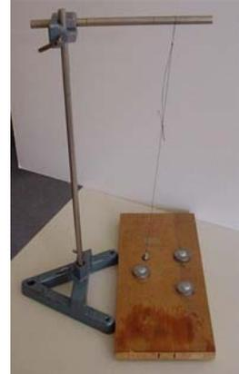
*Vorversuch:* Lenkt das Pendel zunächst ohne Magnete etwas aus, stellt Euch vor, was passieren wird und beobachtet was nach dem Loslassen tatsächlich passiert. Stimmt die Realität mit Euren Erwartungen überein? Ist das Pendel ein deterministisches System?
