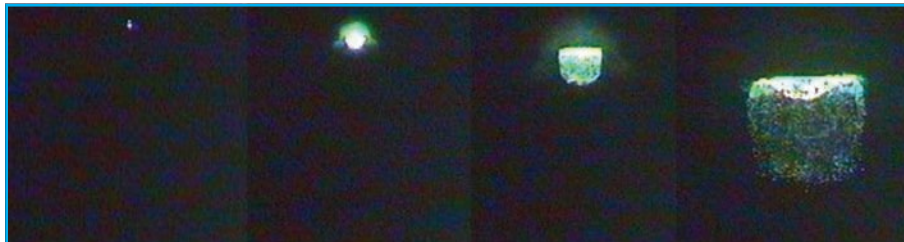
Abb. 1: Laserinduzierte Explosion eines Mikrotröpfchens (bei verschiedenen Zeiten)
