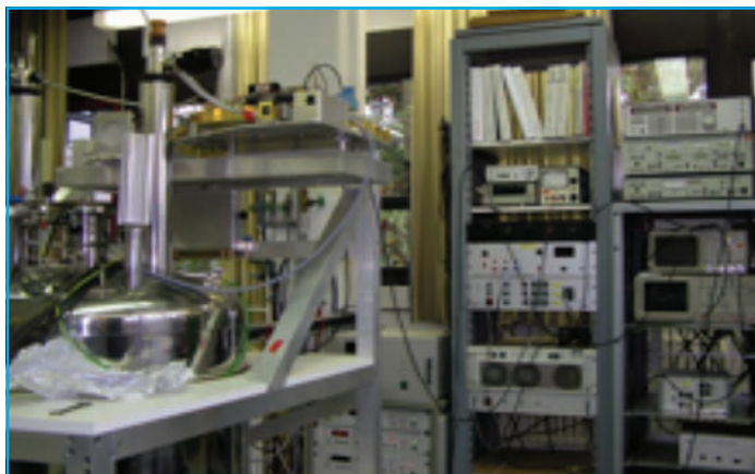
Abb. 3: Höchstfeld- EPR- Spektrometer. Der cryogene Magnet besteht aus zwei supraleitenden Spulen, eine davon weist ein statisches Magnetfeld von 6,4 Tesla auf, was bei g=2 180 GHz entspricht.
