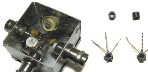
(a) Übertragungsfaktor  $Z = 1 : 4$ , links: Schaltung eines konventionellen, rechts: Schaltung eines Leitungs-Übertragers
