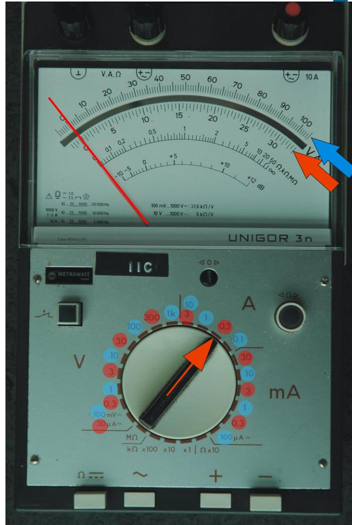
Analoges Drehspulmessinstrument für Strom oder Spannungsmessung. Verfügt über zwei Messskalen. Die obere bzw. untere Skala entspricht allen Drehschalterstellungen, die die Ziffer 1 bzw. 3 beinhalten (siehe blaue und rote Makierungen)
