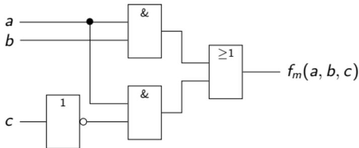
7 Gatter für  $f(a, b, c)$  vs 4 Gatter für minimierte  $f_m(a, b, c)$
