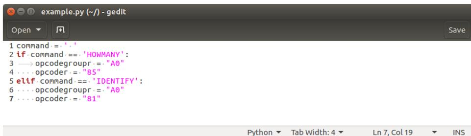
Abbildung 4.12.: Einrückung mit Tab und Leerzeichen, sichtbar
